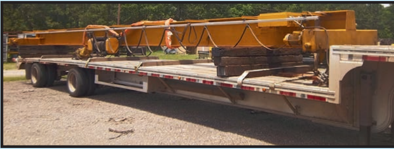
KONE SECO 10 T. CAP. X 45-1/2' BRIDGE CRANE
