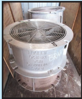
PNEUMATIC JET FAN
