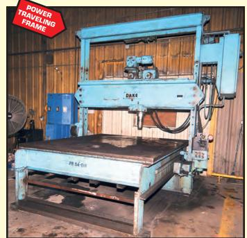
DAKE 175 T. PLATE STRAIGHTENING PRESS
