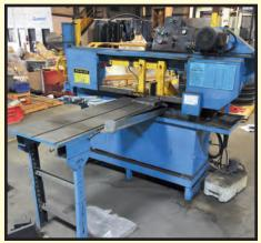
DOALL C-16 SEMI-AUTOMATIC HORIZONTAL BANDSAW
